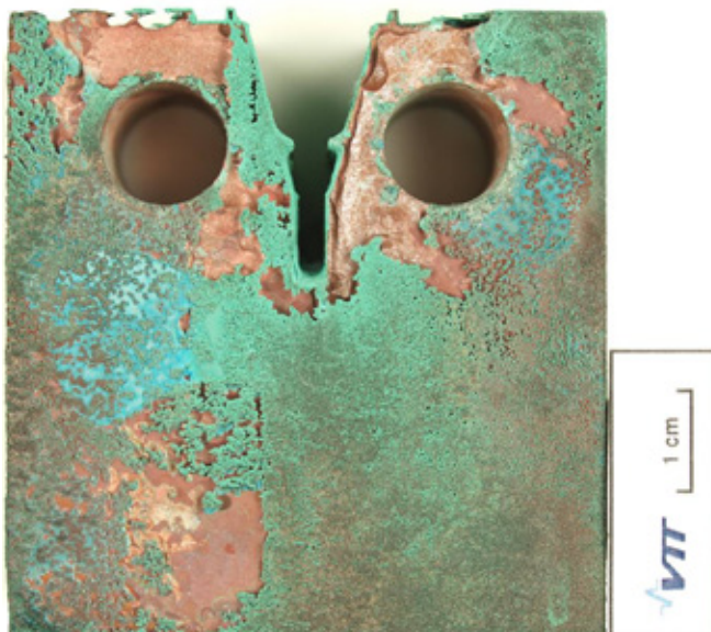
Kuva 7. Yleistä korroosiota CT-sauvassa 4400 tunnin jälkeen 90°C:ssa simuloidussa Olkiluodon pohjavedessä.
