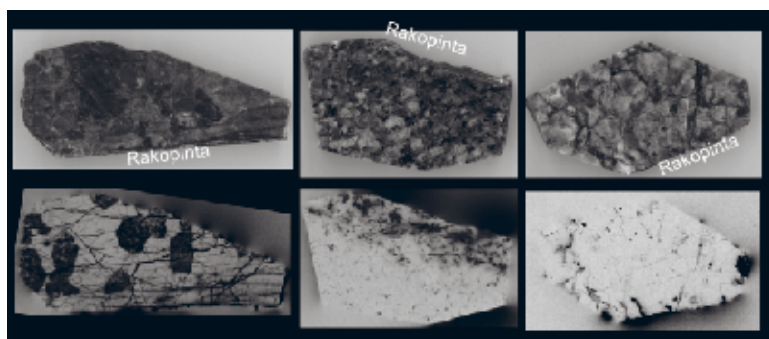
Kuva 40. Askolan näytteiden valokuvat ja C-14 PMMA-autoradiogrammit, joissa havaitaan jatkuvan huokoisuuden jakauma ja radioaktiivisten mineraalien aiheuttamat tummumat.
