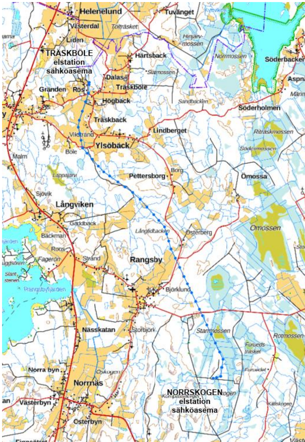
Träskböle-Norrskogen 110 kV Iedningsplatskartan. En ny kraftledning och planerade stolpnas platser är markerade med blå färg.
