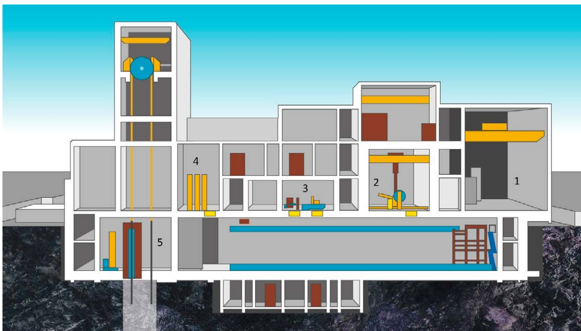
Kuva 4. Pituussuuntainen leikkauskuva kapselointilaitoksesta. Oikealla on kuljetus- ja siirtosäiliöiden vastaanotto- ja varastotila (1). Siitä vasemmalle päin sijoittuvat mm. polttoaineen käsittelykammio (2), kuparikannen hitsauslaite sekä koneistus- ja tarkastusasema (3), tyhjien kapselien vastaanotto- ja varastointitila (4) ja kapselihiisi (5).
