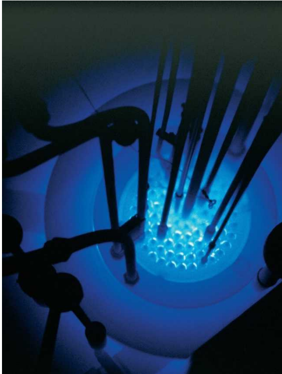
Kuva 4-2. Polttoaine-elementtejä FIR 1 -tutkimusreaktorin reaktorisydämessä.
