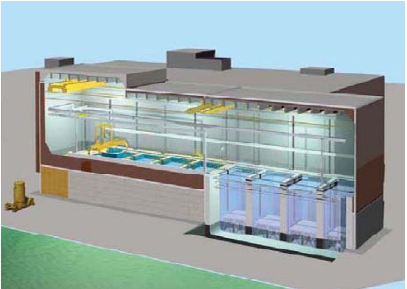
Kuva 12-2 Havainnekuva Loviisan voimalaitoksen käytetyn polttoaineen välivarastosta.
