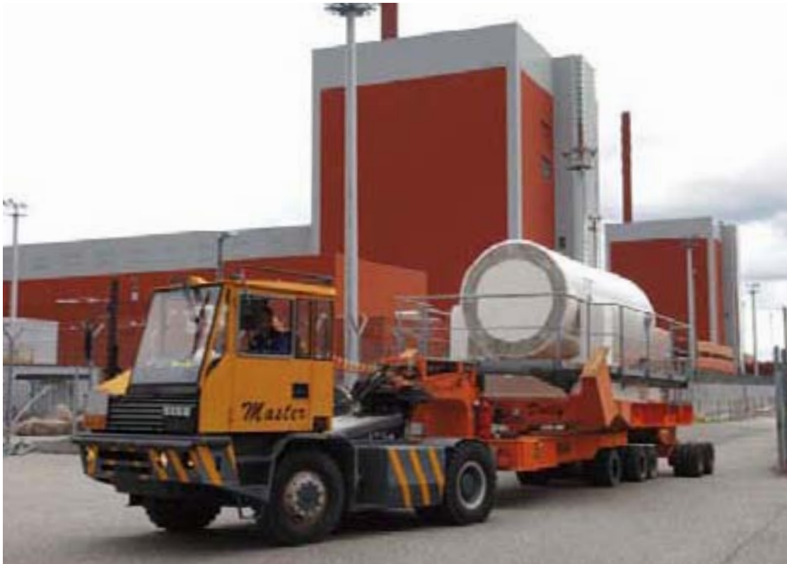
Kuva 3-6 Käytetyn polttoaineen siirtoajoneuvo ja kuljetussäiliö, joilla polttoainetta siirretään Olkiluodon voimalaitosalueella.
