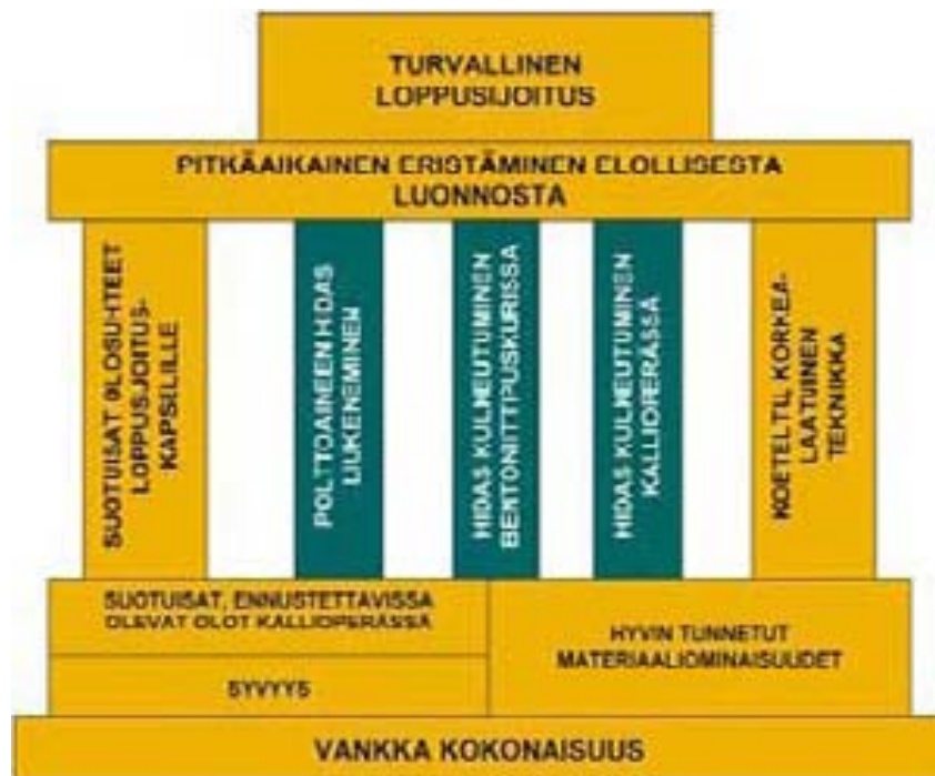
Kuva 11-1 Kiteisessä kallioperässä olevan KBS-3-tyyppisen käytetyn ydinpolttoaineen loppusijoitustilan turvallisuuskonseptin pääpiirteet. Keltaiset palkit kuvaavat turvallisuuskonseptin ensisijaisia turvallisuustoimintoja, joiden tavoitteena on säilyttää vapautumisesteiden, ennen kaikkea kapselin, toimintakyky. Vihreät palkit edustavat toissijaisia turvallisuuspiirteitä, jotka voivat tulla merkittäviksi siinä tapauksessa, että radionuklideja pääsee vapautumaan kapselista.
