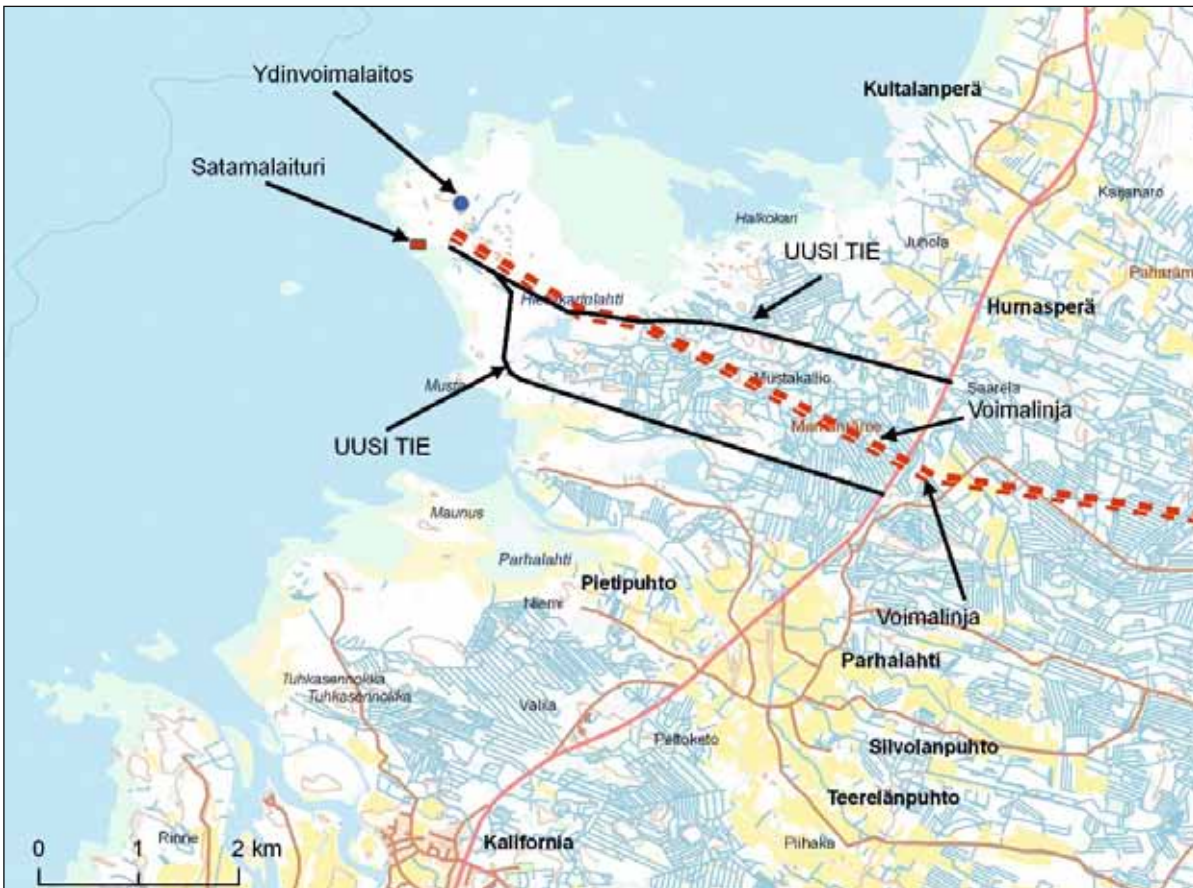
Kuva 3-17. Nykyinen tieverkko Pyhäjoen sijaintipaikan ympäristössä ja parannettava tieosuus sekä rakennettavien voimajohtojen ja satamalaiturin sijoittuminen.
