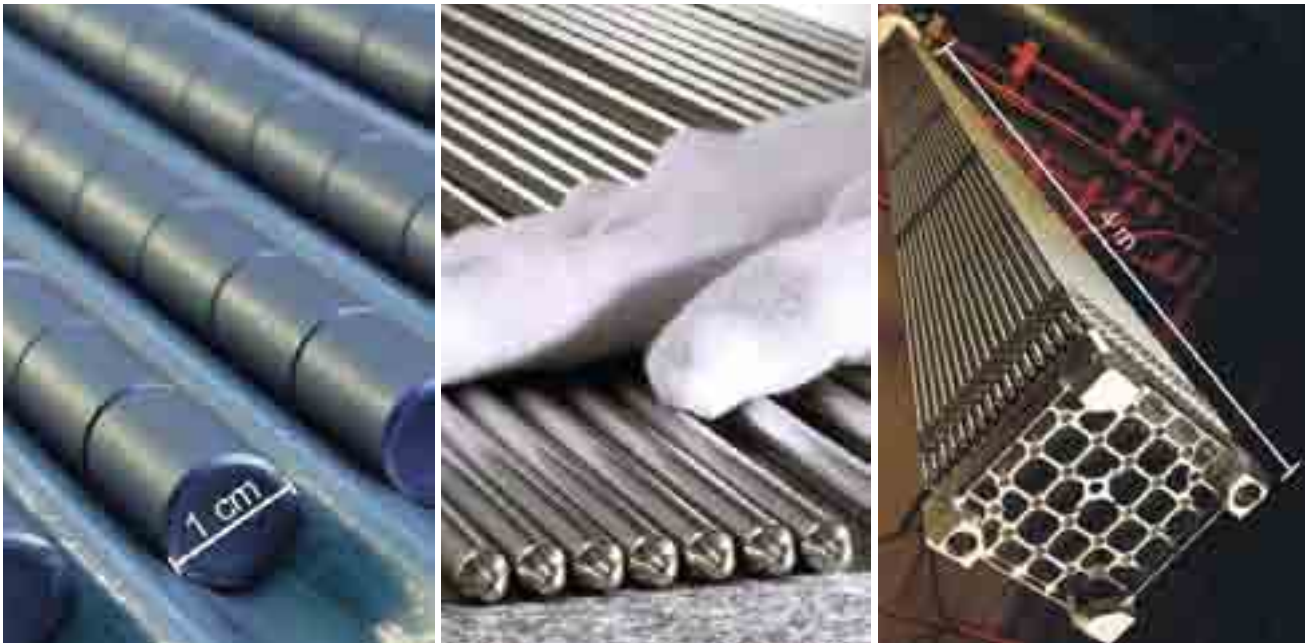
Kuva 3-3. Ydinpolttoaine: Polttoainetabletit, polttoainesauvat, polttoainenippu.
