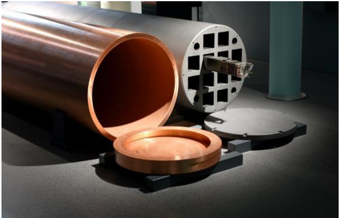
Kuva 3-6. Loppusijoituskapselin sisäosa ja ulkokuori. Kuvassa Olkiluoto 1:n ja 2:n kapseli, jonka halkaisija on 1,05 metriä ja pituus 4,8 metriä. Kuva: Posiva Oy. Fennovoiman kapselit ovat tästä hieman pidempiä ja niiden sisäosa on erilainen.
