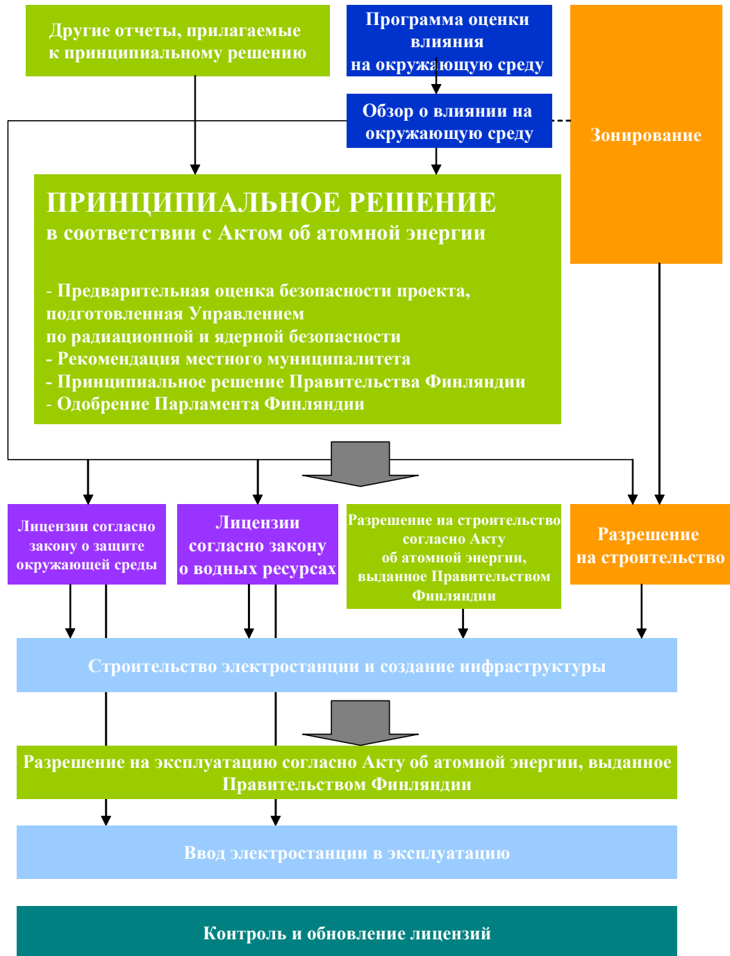
Рис. 2-1. Этапы разрешительной процедуры для строительства и эксплуатации атомной электростанции
