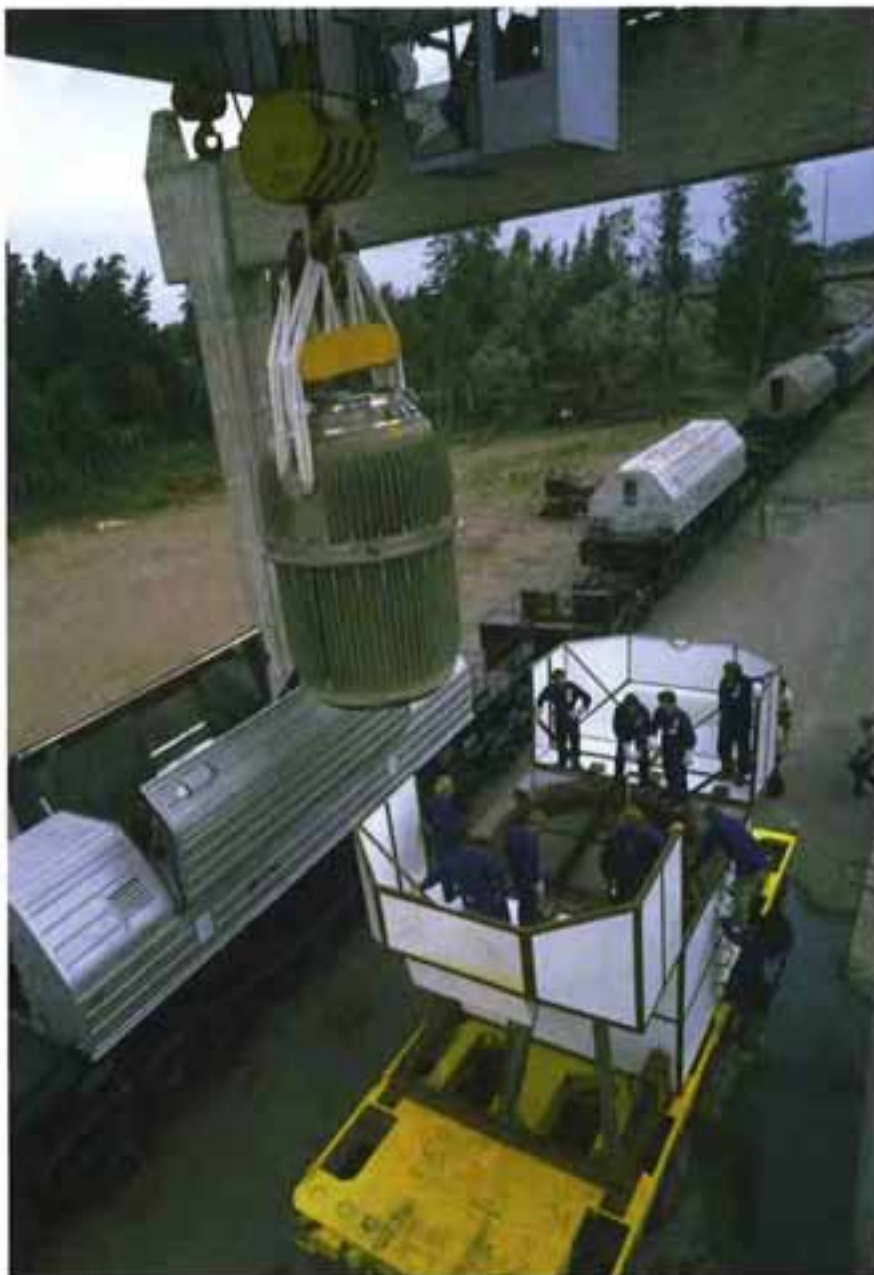
Fig. 4-7. Använt kärnbränsle transporterades 15 gånger per järnväg 1981-96 från Lovisa till Sovjetunionen (senare Ryssland). Det använda bränslet transporterades per landsväg från Hästholmen till järnvägsstationen i Lovisa där transportbehållarna lastades i tågagnar. Vid transporterna användes ryska transportbehållare.
