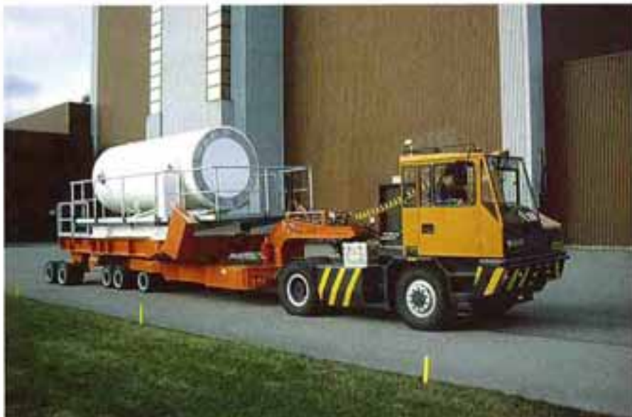
Fig. 4-10. Transportbehållare för använt kärnbränsle. På bilden transporteras behållaren från kärnkraftverket i Olkiluoto till mellanlagret på kraftverksområdet.
