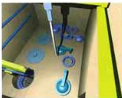
Fig. 4-16. Inkapslingsanläggningens isolerade hanteringscell. Transportbehållaren kopplas tätt till hanteringsceller till vänster. En fjärrstyrd hanteringsmaskin placerar bränsleelementen ett i sänder i kopparkapseln som kopplats till cellen längst bak till höger.
