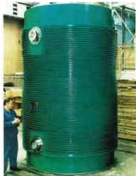
Fig. 4-8. Castor-VVER-behållare som lämpar sig för transport av använt kärnbränsle från Lovisa. Transportbehållaren väger ca 110 ton, den är ca 4,1 m lång och dess diameter är 2,7 m. Den rymmer 84 bränsleelement.
