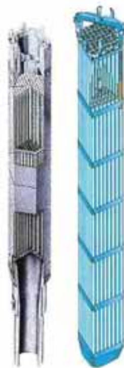
Fig. 2-2. Skiss av Lovisas (t.v.) och Olkiluotos bränsleelement.
