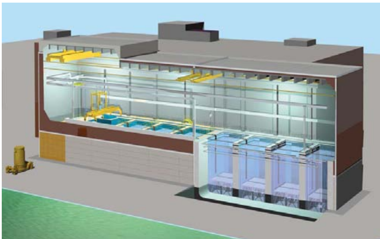
Bild 12-2 Illustration av mellanlagret för använt kärnbränsle vid Lovisa kraftverk.
