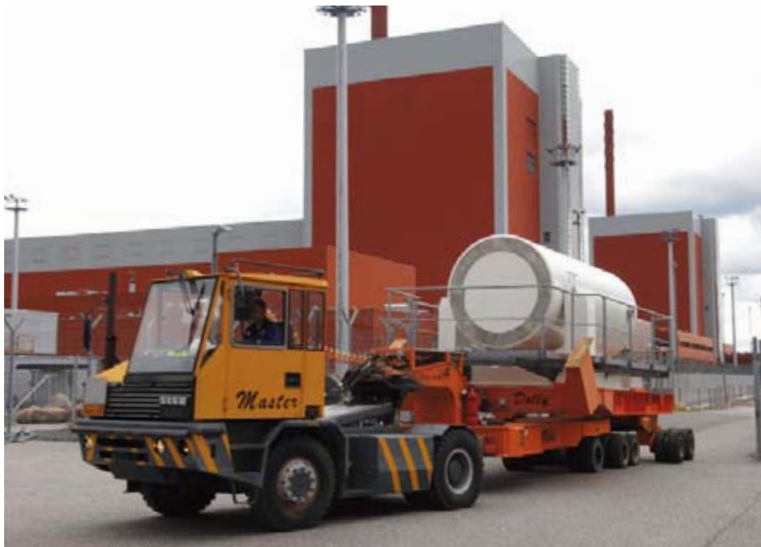
Bild 3-6 Transportfordon och transportbehållare för använt kärnbränsle, som används för att förflytta bränsle inom kraftverksområdet i Olkiluoto.
