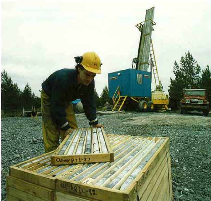
Kuva 1-3. Kallionäytekairauksia on tehty yli kilometrin syvyyteen.
