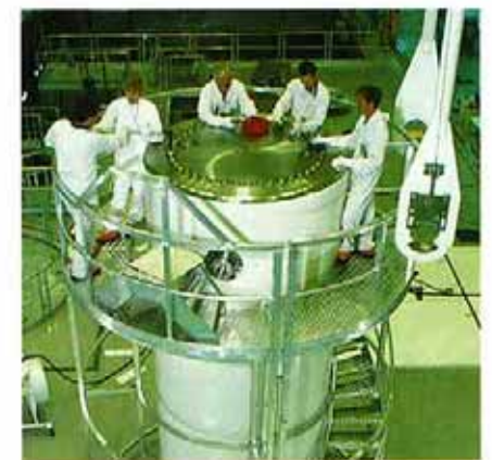
Kuva 4-9. Olkiluodon käytetyn ydinpolttoaineen Castor-TVO-siirtosäiliö. Säiliön paino on noin 80 t, pituus 5,2 m ja läpimitta 2,0 m ja siihen mahtuu 41 polttoaineniippua.
