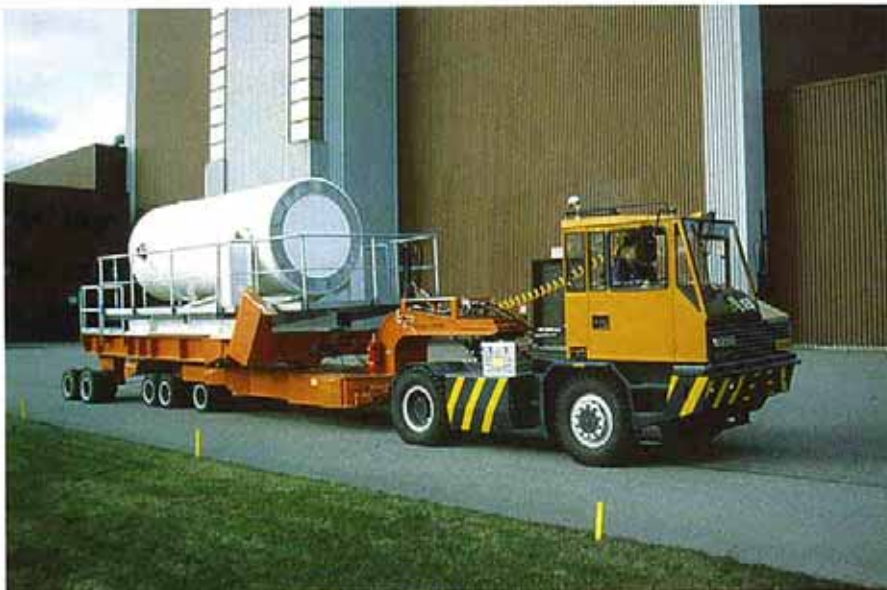
Kuva 4-10. Käytetyn ydinpolttoaineen kuljetussäiliö. Kuvassa säiliötä siirretään Olkiluodon ydinvoimalaitokselta voimalaitosalueella sijaitsevaan välivarastoon.
