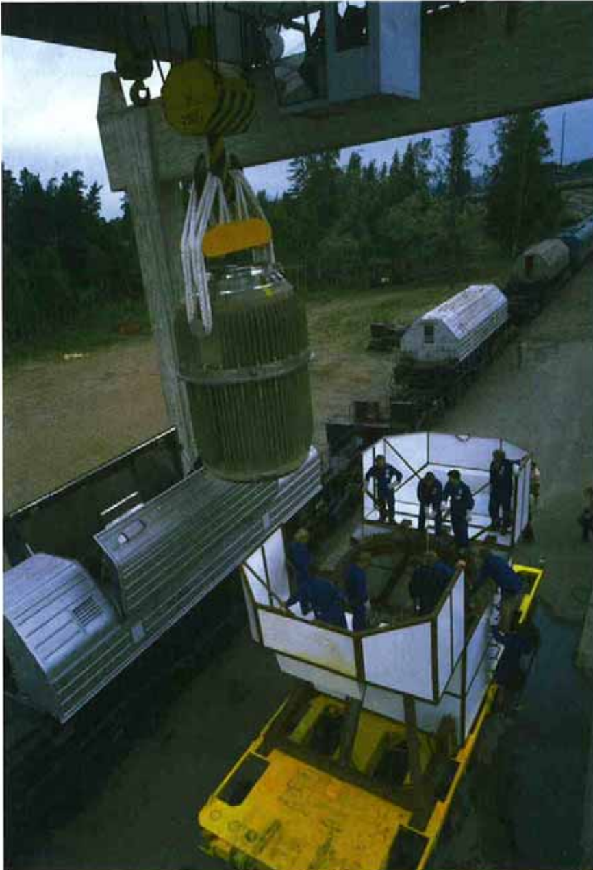
Kuva 4-7. Käytettyä ydinpolttoainetta kuljetettiin vuosina 1981–1996 Loviisasta Neuvostoliittoon (myöhemmin Venäjälle) rautateitse 15 kertaa. Käytetty polttoaine siirrettiin maanteitse Hästholmenista Loviisan rautatieasemalle, jossa kuljetussäiliöt lastattiin junavaunuihin. Kuljetuksissa käytettiin venäläisiä kuljetussäiliöitä.
