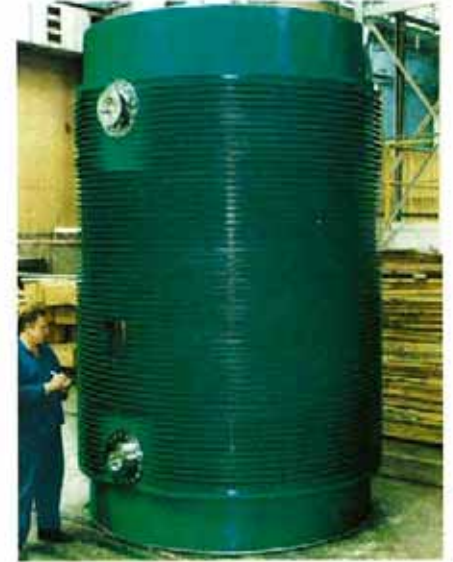
Kuva 4-8. Loviisan laitoksen käytetyn ydinpolttoaineen kuljetukseen soveltuva Castor-VVER -säiliö. Kuljetussäiliön paino on noin 110 t, pituus noin 4,1 m ja läpimitta 2,7 m, ja siihen mahtuu kerrallaan 84 nippua.
