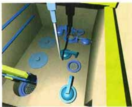
Kuva 4-16. Eristetty käsittelykammio. Kuljetussäiliö kytketään tiiviisti vasemmalla näkyvään asemaan. Kauko-ohjattu siirtokone asentaa polttoaineniput yksittellen kuparikapseliin, joka on kytketty takana oikealla olevaan asemaan.
