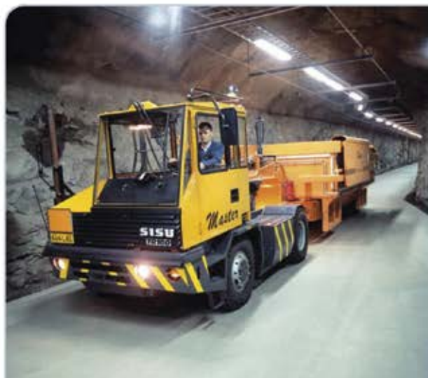
Ett specialfordon transporterar avfallsförpackningarna till Olkiluoto's grotta för kraftverksavfall, KVA-grottan.
