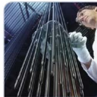
Reaktorstyrelementens fingerstavar rör sig i styrrören inuti knippet. Samma styrrör används även för att placera instrumentering och neutronkällor.
