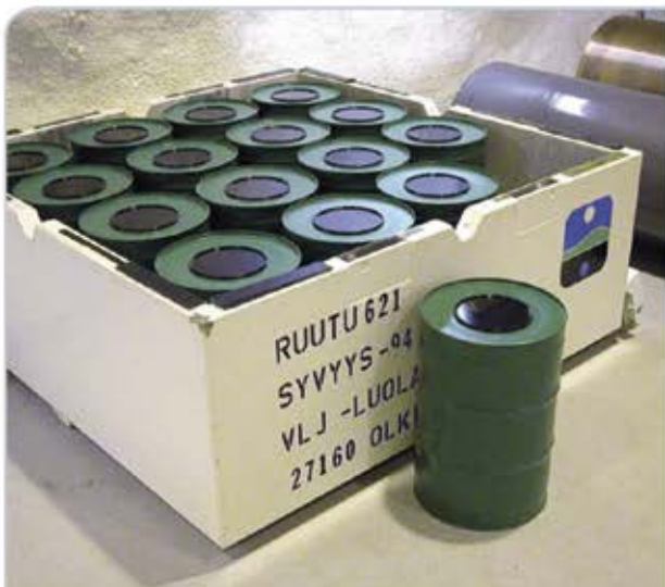
En del av det fasta kraftverksavfallet förpackas i 200 liters tunnor.
