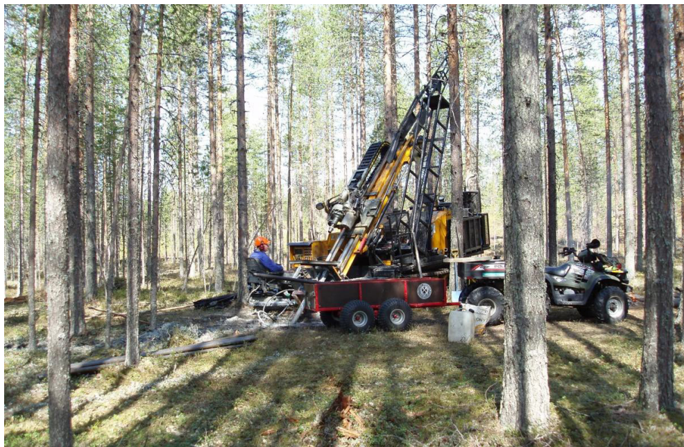
Kuva 7. Yläkuvassa timanttikairausta, alakuvassa hyseinen kairauspaikka honeen poistuttua paikalta. (Kuvat Tapio Halkoaho, GTK)
