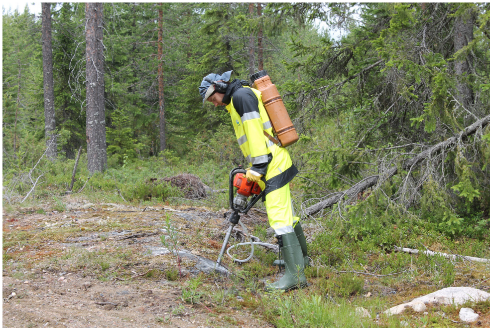
Kuva 8. Kallionäytteenotto minikairalla. (Kuva Tapio Halkoaho, GTK)
