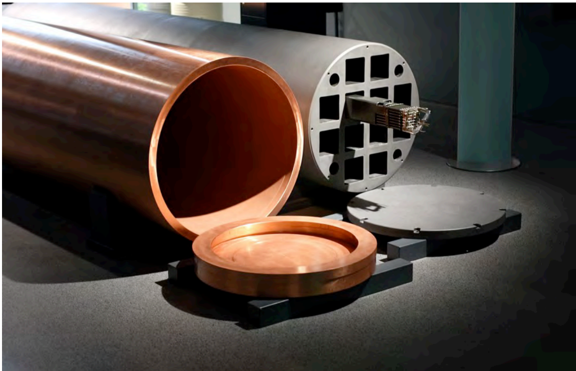
Bild 3-6. Insats och hölje för en slutförvaringskapsel. På bilden syns en kapsel för Olkiluoto 1 och 2, som mäter 1,05 meter i diameter och 4,8 meter på längden. Bild: Posiva Oy. Fennovoimas kapslar är något längre och har en annan typ av insats.
