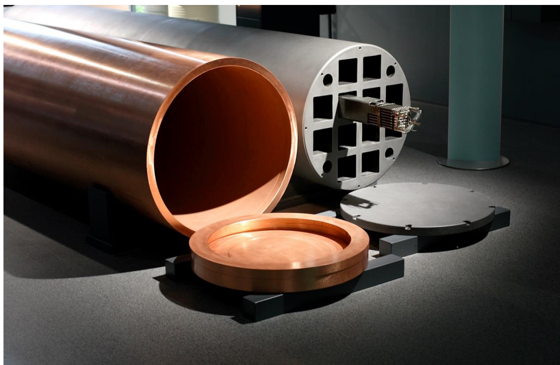
Figur 2. Indsats og yderskal på en deponeringsbeholder. På billedet ses en beholder fra Olkiluoto 1 og 2. Den har en diameter på 1,05 meter og er 4,8 meter lang. Billede fra Posiva Oy. Fennovoima-beholderne vil være en anelse længere og have en anden slags indsats.
