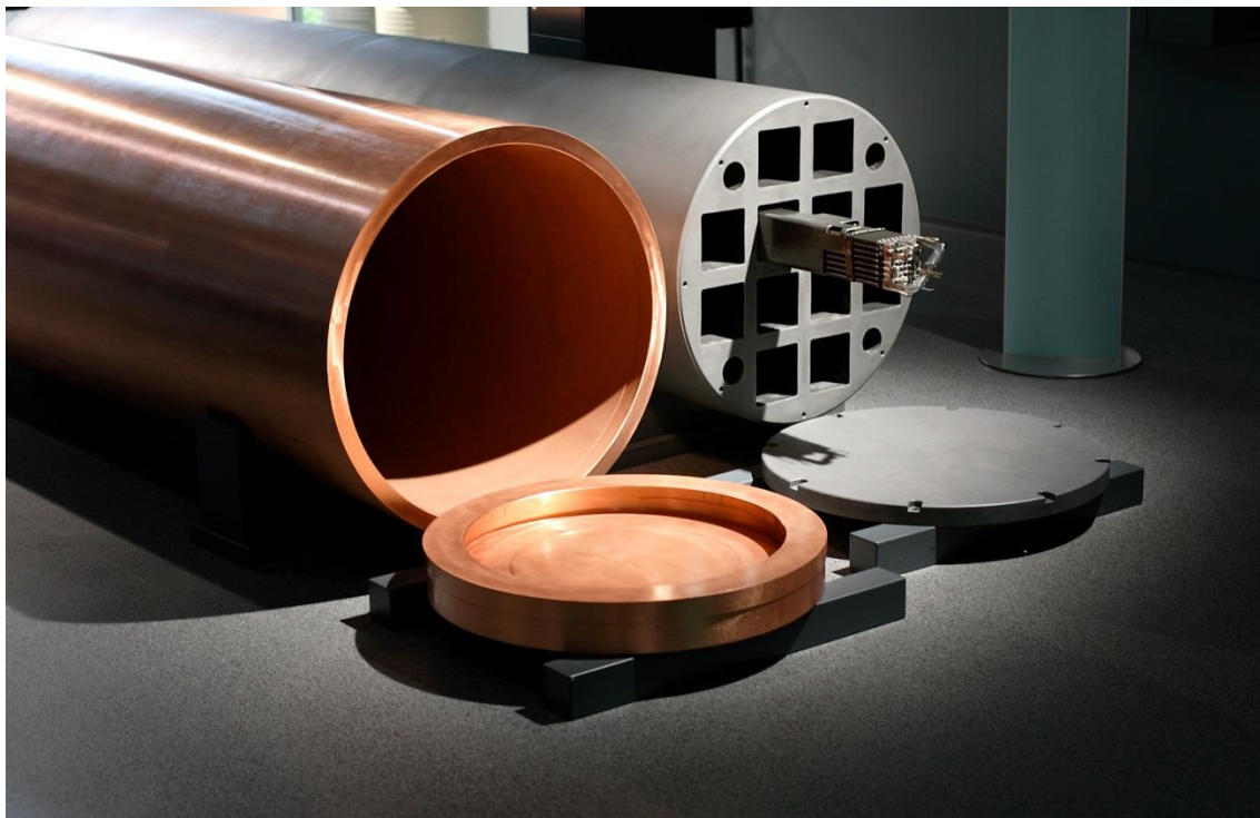
Joonis 2. Ladustuskanistri siseosa ja väliskest. Pildil on Olkiluoto 1 ja 2 jaoks ette nähtud kanister. Selle läbimõõt on 1,05 meetrit ja pikkus 4,8 meetrit. Allikas: Posiva Oy. Fennovoima kanistrid on pisut pikemad ja neil on teistsugune siseosa.
