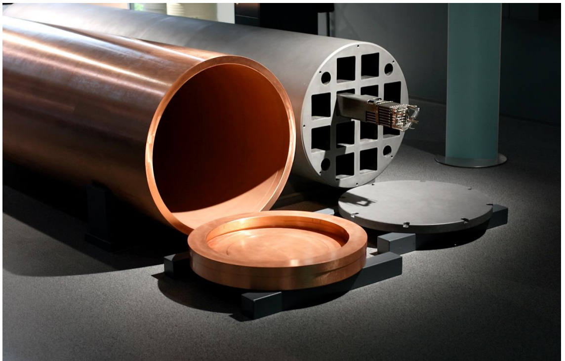
Abb. 2. Der Einsatz und die Außenhülle eines Entsorgungskanisters. In der Abbildung ist ein Kanister für Olkiluoto 1 und 2 zu sehen. Der Kanister hat einen Durchmesser von 1,05 Metern und ist 4,8 Meter lang. Abbildung der Posiva Oy. Die Fennovoima-Kanister werden ein wenig länger sein und verfügen über einen anderen Einsatztyp.
