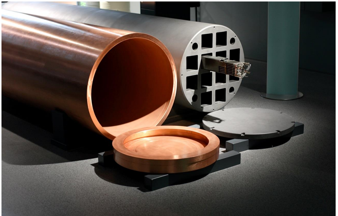
Kuva 2. Loppusijoituskapselin sisäosa ja ulkokuori. Kuvassa Olkiluoto 1:n ja 2:n kapseli, jonka halkaisija on 1,05 metriä ja pituus 4,8 metriä. Kuva: Posiva Oy. Fennovoiman kapselit ovat tästä hieman pidempiä ja niiden sisäosa on erilainen.
