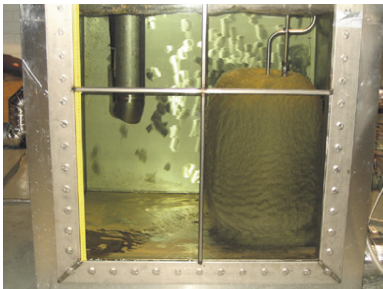
Kuva 5.5. Täysimittakaavainen suodatinelementti LUT:n sumppinkokeessa. Piirissä ollut eristevilla on kerääntynyt suodatinelementtiin kokeen aikana. (Kuva: Jani Laine)
