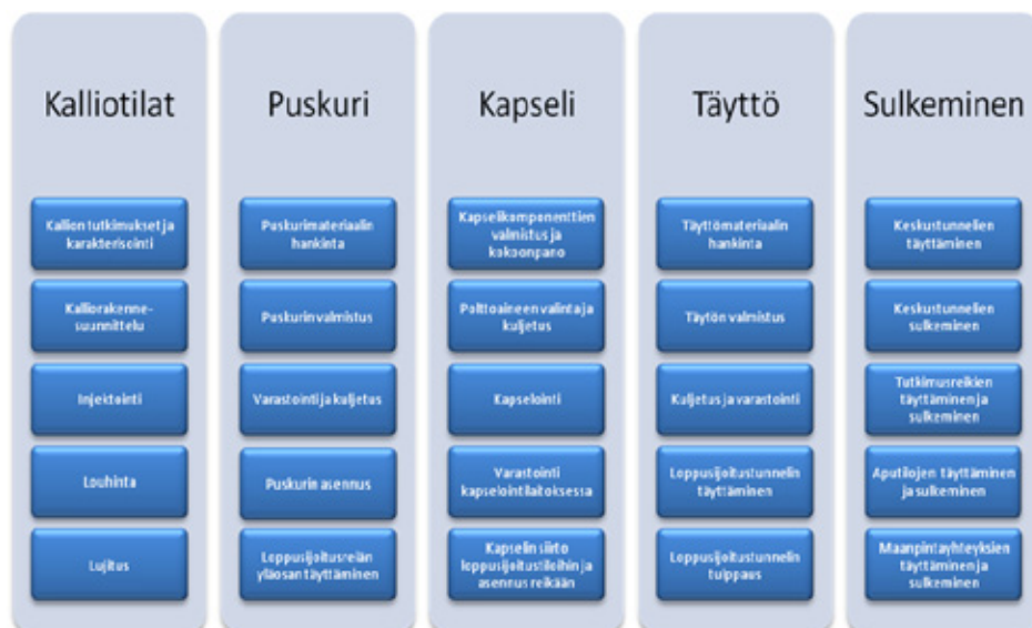
Kuva 4.11. Loppusijoitusjärjestelmä esitettynä työvaiheita kuvaavina tuotantolinjoina. (Kuva: Posiva)
