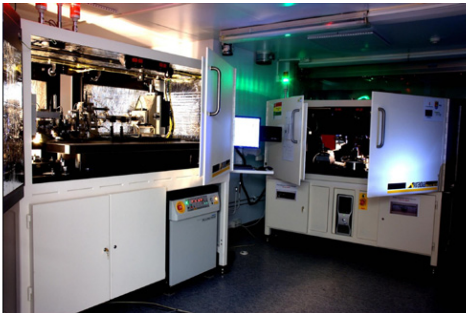
Kuva 5.14. Näkymä JYFL:n Tomografialaboratoriosta. Oikealla Xradia MicroXCT 400 -mikrotomografialaite ja vasemmalla Xradia NanoXCT -nanotomografialaite.
