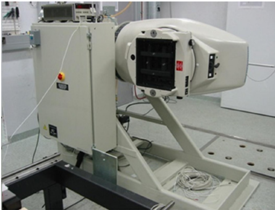
Kuva 5.16. ^{60}\text{Co} -gamma-säteilytin GBX200, säteilylähteen aktiivisuus on 400 TBq.
