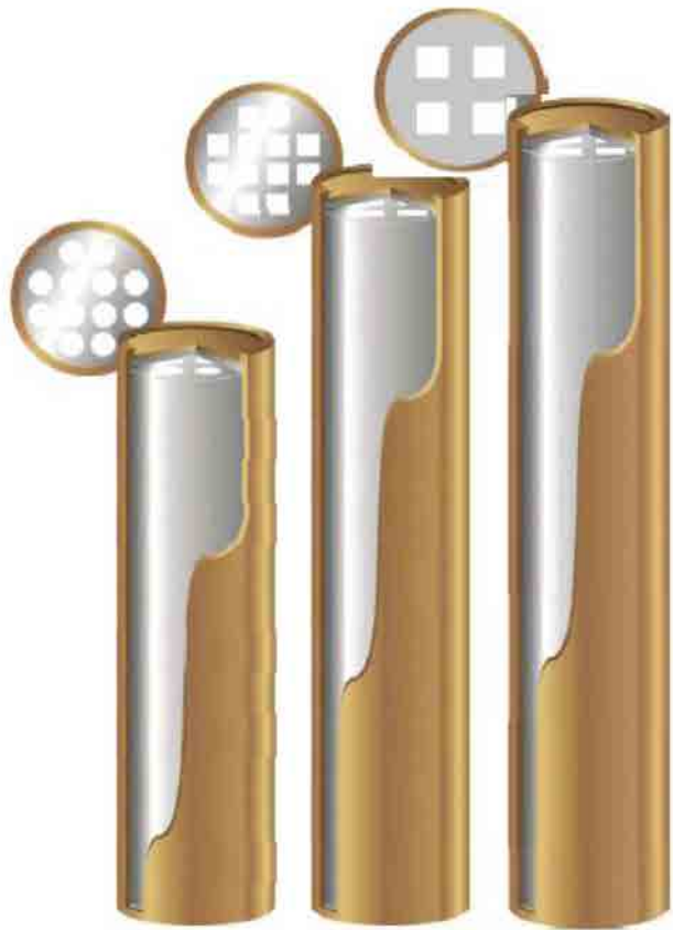
Kuva 4. Kupari-rauta kapselit; vasemmalla Loviisa 1-2 (VVER 440) -kapselityyppi, Olkiluoto 1-2 (BWR) keskellä ja Olkiluoto 3 (EPR, OL3) oikealla.
