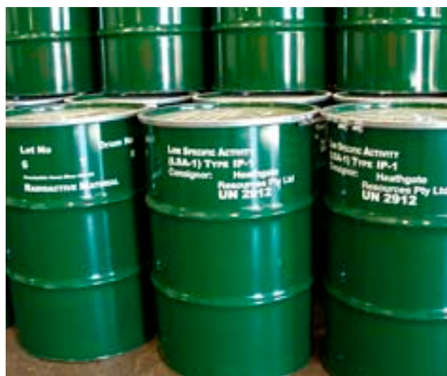
■ Kuva 5-5. Esimerkki uraanipuolituotteen kuljetuksissa käytettävästä tynnyristä (kuva: O. Äikäs, GTK, 2008).
