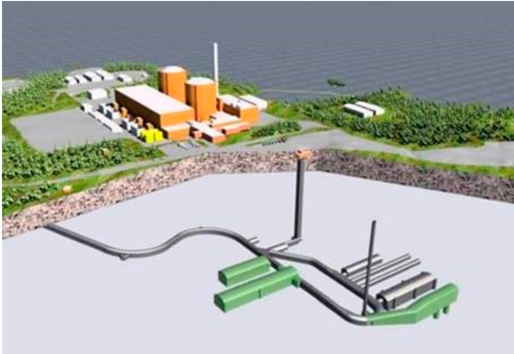
Kuva 5. Loviisan matala- ja keskiaktiivisen jätteen loppusijoituslaitos. Käytössä olevat tilat on merkitty harmaalla ja suunnitteilla oleva laajennus vihreällä. (lähde: Fortum).
