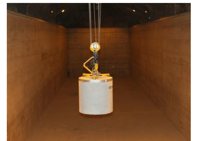
Bild 4-15. Flyttning av den första förpackningen för solidifierat avfall till betongbassängen i hallen för solidifierat avfall i december 2019.
