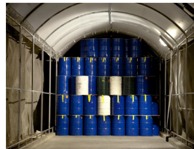
Bild 4-14. Serviceavfallstunnor staplade på varandra i slutförvarsutrymmet.
