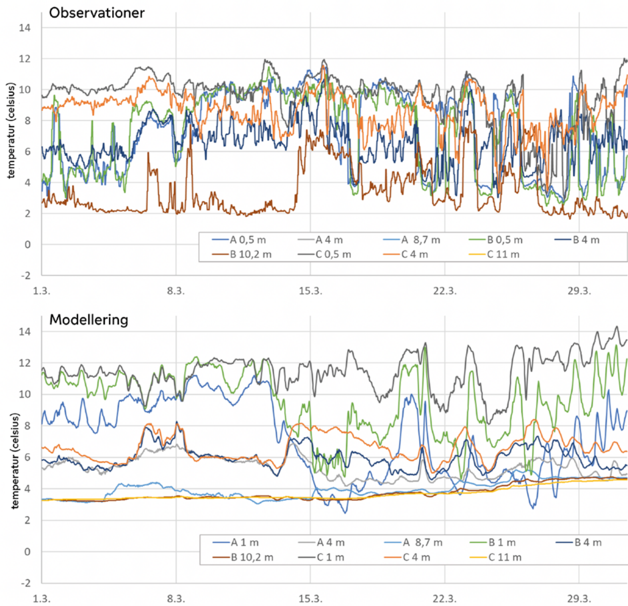
Bild 4-11. Observerad och modellerad vattentemperatur på olika djup vid kylvattenutloppet i Hästholmsfjärden vid bojarna A, B och C (bild 3-3) i mars 2018.
